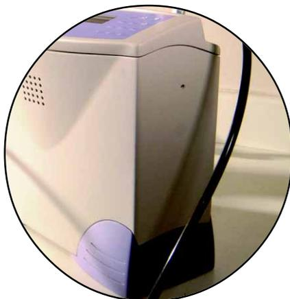
аэрозоль, а по другой отводится газ для анализа. При тестировании можно выбрать соответствующую программу из 100 уже имеющихся стандартных профилей или ввести индивидуальные параметры (например, время тестирования и объем корпуса фильтра).
