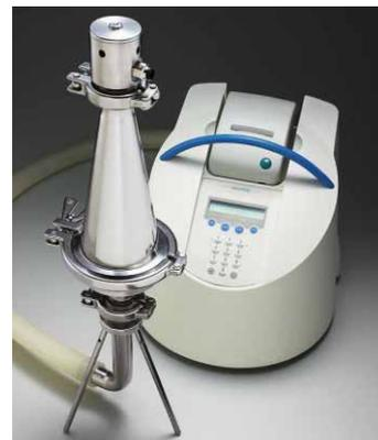
**Прибор M Air T для анализа сжатых газов**
