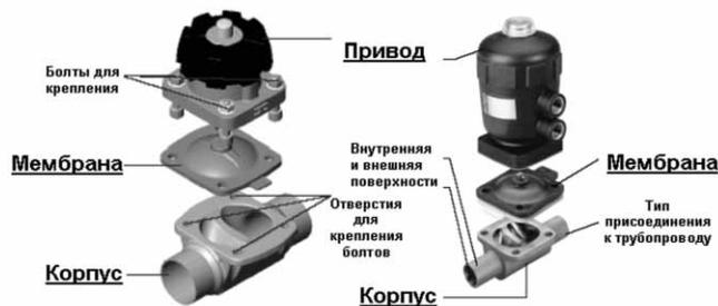
Для управления работой мембранных вентилях обычно используются ручной привод (manual operated valve), пневмопривод (pneumatic valve), электропривод (motorized valve). В качестве материалов для изготовления приводов используют нержавеющую сталь и различные полимерные материалы. По видам материалов конструкции приводы могут быть разделены на автоклавируемые и неавтоклавируемые (т.е. подвергающиеся и неподлежащие термической стерилизации автоклавированием).
