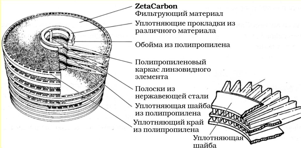
Рис. 2. Конструкция фильтропатрона Зетакарбон
