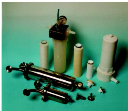
разделить на две группы: **мембранные** (преобладает поверхностный, экранный механизм задержания частиц) и **глубинные** (удержание частиц происходит в объеме фильтрующего материала). По конструктивному исполнению выпускаемые фильтроэлементы являются патронными. Кроме того, выпускаются плоские дисковые мембраны диаметром от 25 до 293 мм.
