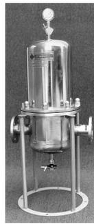
вого) расхода газа. Самый большой фильтродержатель, рассчитанный на очистку воздуха с производительностью до 500 м³/час, имеет внутренний объем 24,5 дм³, таким образом, на него не распространяются ограничения в эксплуатации, как на сосуд, находящийся под давлением.
