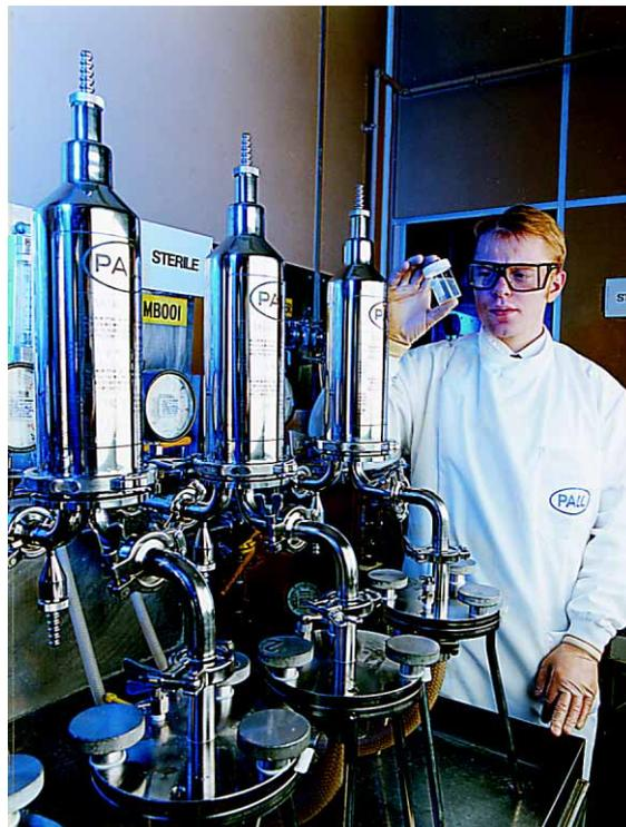
испытания на степень выделения частиц и эндотоксинов, определение величины сдвига pH, ТОС и проводимости, а также относящиеся к данной партии результаты теста задержания бактерий.
