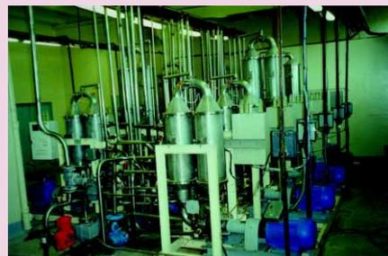
Рис. 3. Микрофильтрационная установка МФС-4Х20-3Х10 (поверхность керамических мембран - 112,2 м<sup>2</sup>). Производительность по фильтрату - 7000 ... 9000 л/ч. Используется для очистки растворов (культуральных жидкостей) в производстве антибиотика erythromycin (г. Курган, Россия).
