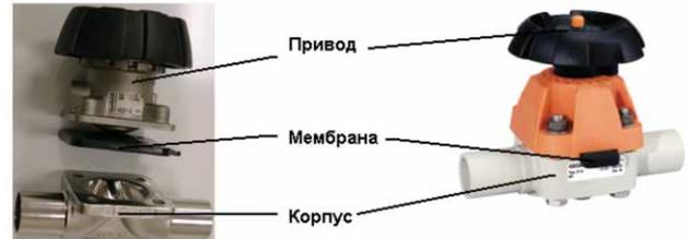
Несколько другую, запатентованную конструкцию имеют мембранные вентили шведской компании **NovAseptic AB**, обладающие улучшенными гидродинамическими характеристиками и обеспечивающими максимальную герметичность и отсутствие застойных зон. В отличие от других фирм-производителей мембрана вентиля непосредственно покрывает шток привода. Для обеспечения герметичности и отсутствия застойных зон используются дополнительные конструктивные особенности (см. рисунки ниже).
