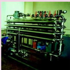
Рис. 2. Фильтрационный модуль УМС-80
