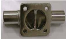
Одним из критических параметров качества выпускаемых мембранных вентилях является степень шероховатости внутренней поверхности. Для систем распределения воды очищенной и воды для инъекций шероховатость внутренней поверхности из нержавеющей стали должна составлять менее 0,8 мкм (в критических точках – до 0,4-0,6 мкм). Для обеспечения такого качества поверхности применяется механическая или электрополировка.
